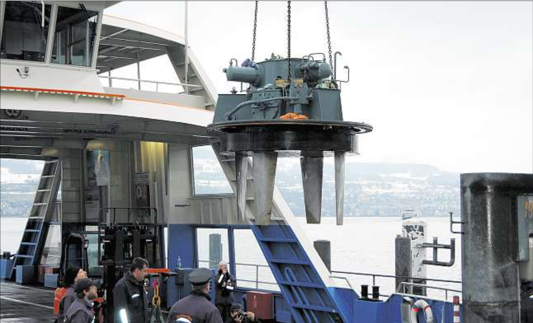
Die beiden Voith-Schneider-Propeller wurden gestern von der Fähre «Schwan» abmontiert und in Revision gebracht. Einer wiegt sieben Tonnen. (Roger Geier)
